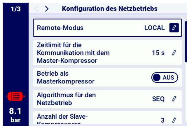
Abbildung 38: Konfigurationsmenü für den Netzbetrieb 1/3
