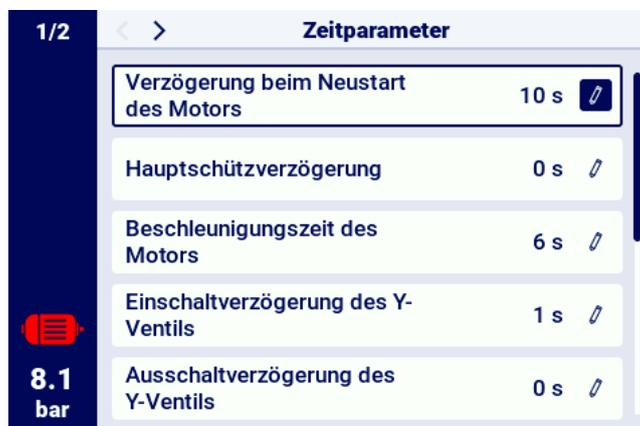
Abbildung 27: Menüansicht mit Zeitparametereinstellungen für die Umrichterkonfiguration
