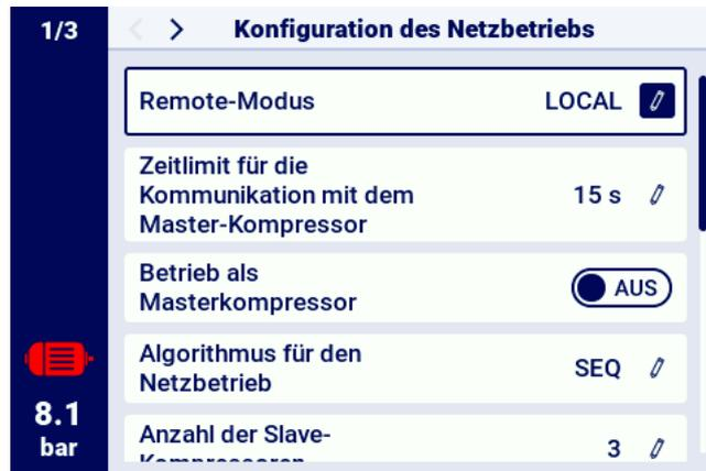
Abbildung 12: Parameterkacheln mit einem Beispiel für eine Untergruppe der Konfigurationsparameter für den Netzbetrieb
