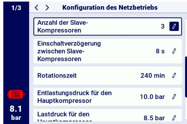
Abbildung 39: Konfigurationsmenü für den Netzbetrieb 2/3
