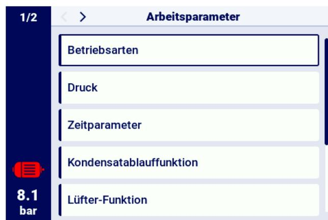
Abbildung 11: Kacheln mit Parameteruntergruppen am Beispiel von Betriebsparametern
