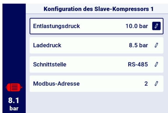
Abbildung 42: Slave-Verdichter-Konfigurationsmenü 1
