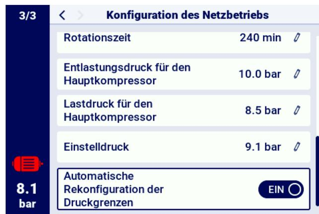
Abbildung 40: Konfigurationsmenü für den Netzbetrieb 3/3
